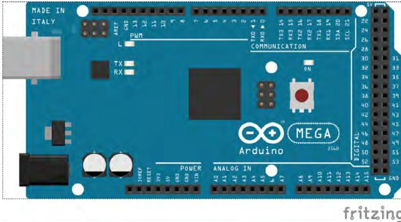
Fig 5.7 – Arduino Mega ha 54 pin di ingresso/uscita digitali
