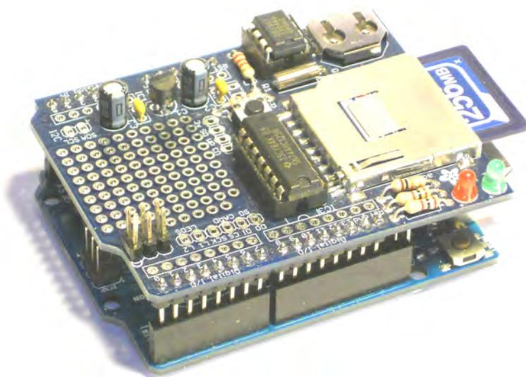
Fig 2.18 – Un «panino» composto da Arduino e un Data Logger Shield..
