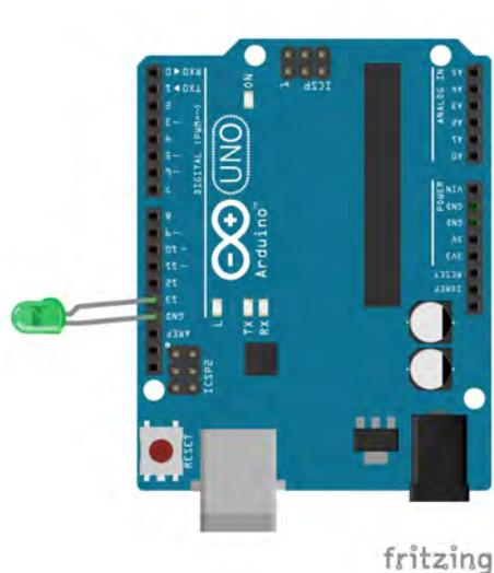
Fig 5.10 – LED collegato senza resistenza sui pin 13 e GND.
