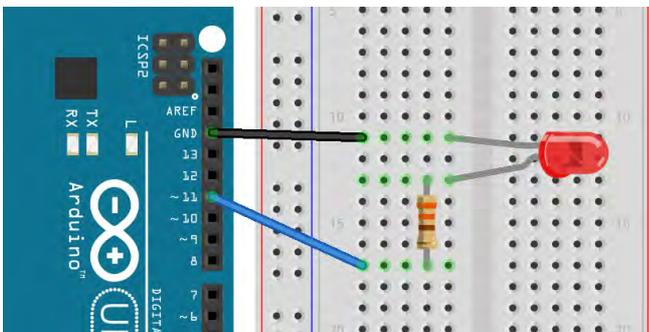
*Fig 5.17 – collegamento di un LED al pin 11 per l'esperimento con il segnale PWM.*
