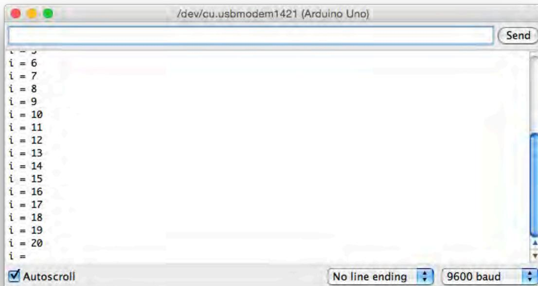
Fig. 5.20 – Serial monitor con la sequenza progressiva di numeri trasmessi da Arduino.
