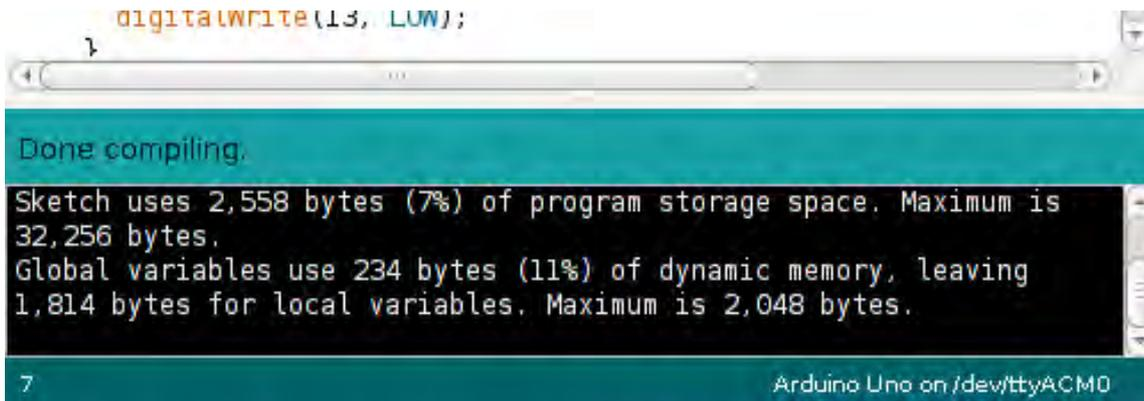
Fig 5.3 – Messaggi presenti nell'area inferiore della finestra di Arduino a seguito di un upload senza errori.
