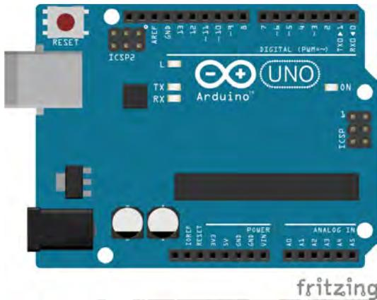
Fig 3.4 – Per il primo esperimento non vi serve nient'altro che Arduino: utilizzate il LED integrato sulla scheda (indicato con «L»).
