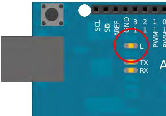
Fig 5.9 – Il LED integrato sulle schede Arduino è collegato al pin 13.
