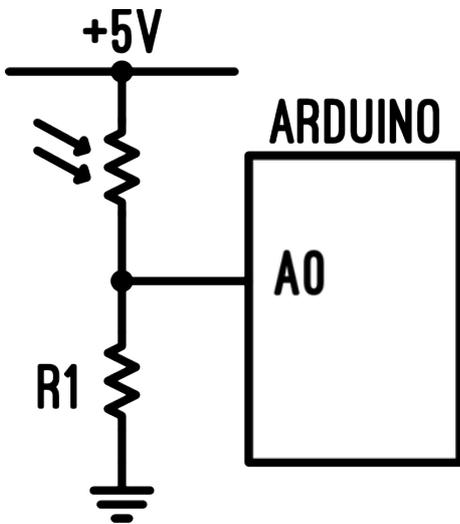
Fig. 5.21 – Schema elettrico del circuito per collegare una foto resistenza ad Arduino.
