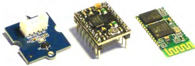
*Fig 2.19 – Piccole schede per microcontrollori: sensore di temperatura, driver per motori e modulo Bluetooth.*
