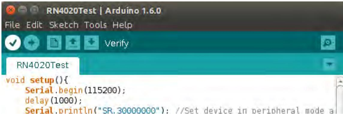
Fig. 5.1 – La finestra di Arduino con evidenziato il pulsante per la verifica dello sketch.
