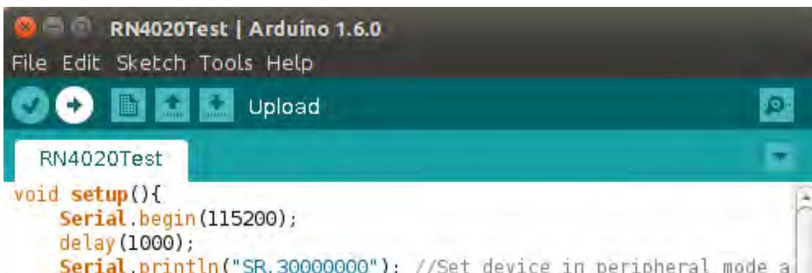
Fig. 5.2 – La finestra di Arduino con evidenziato il pulsante «upload» per caricare lo sketch.
