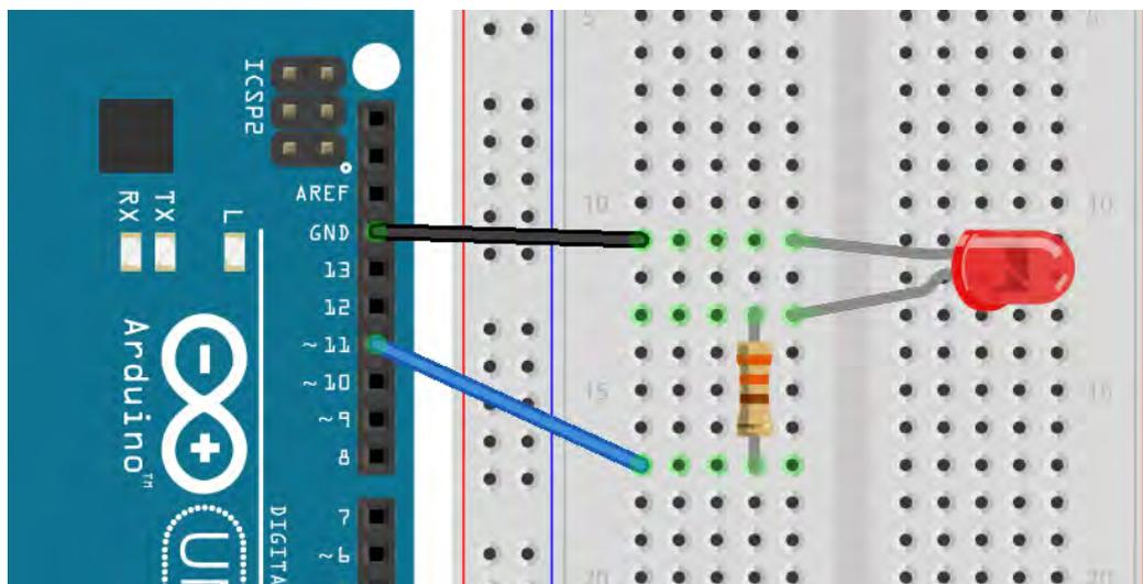
Fig 5.12 - Composizione del circuito elettrico con Arduino, una resistenza e un LED sul pin 11.
