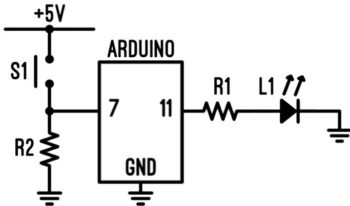
Figura 5.14 – Schema elettrico di collegamento di un pulsante ad Arduino.
