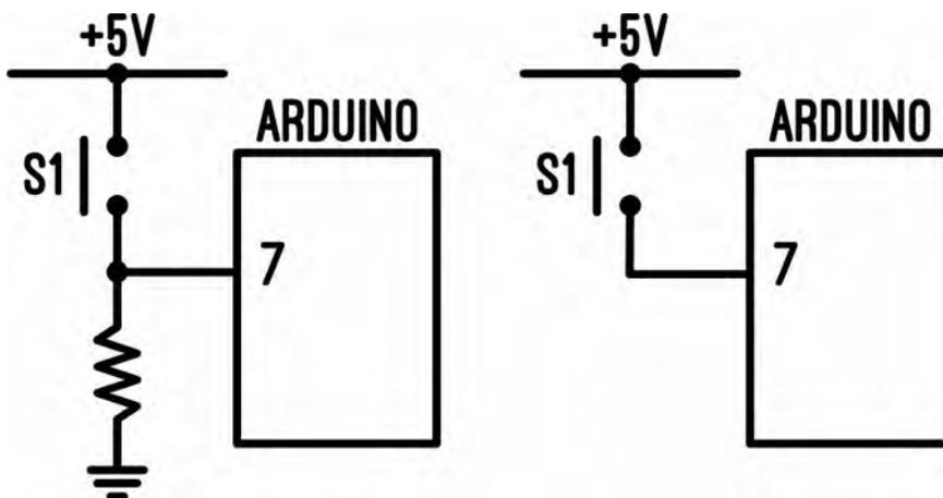
Fig. 5.16 – nello schema a sinistra il pulsante è collegato correttamente ad Arduino, lo schema si destra mostra come non dovreste mai collegare un pulsante a un microcontrollore.
