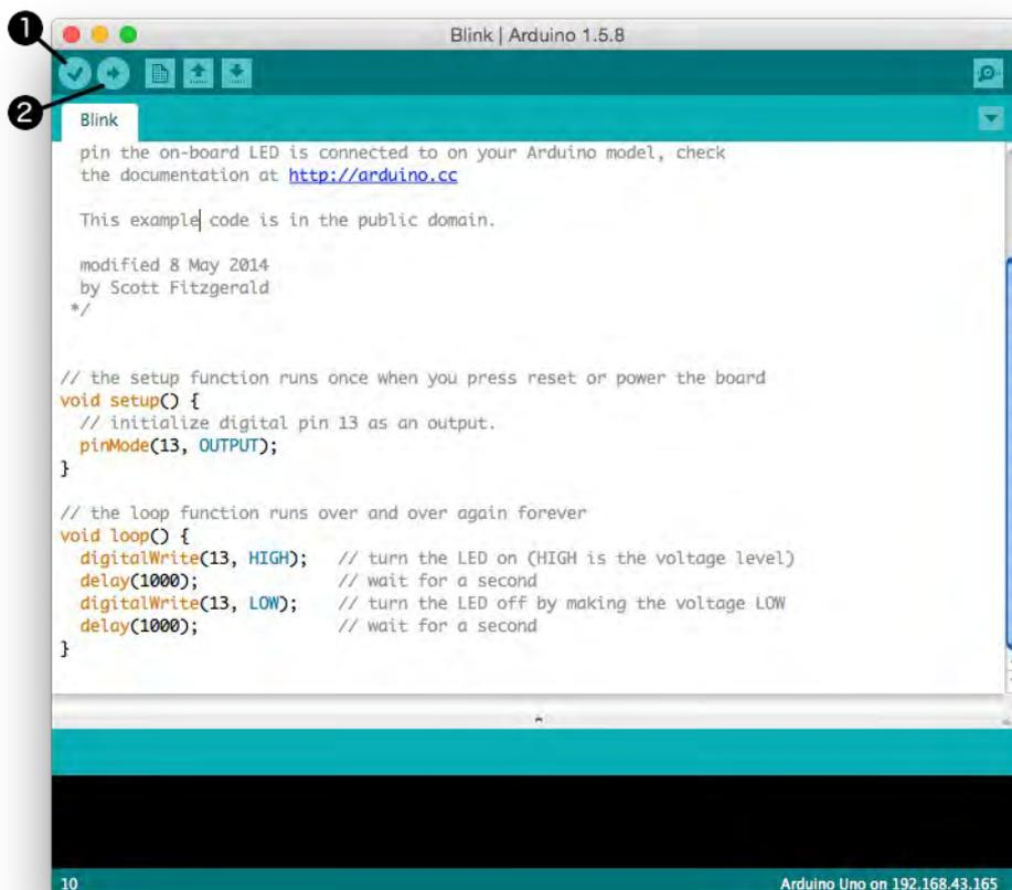
Fig 3.6 – Finestra di Arduino con caricato lo sketch Blink. Nella toolbar trovate i pulsanti «Verify» per controllare il listato (1) e «Upload» per caricarlo sulla scheda (2).
