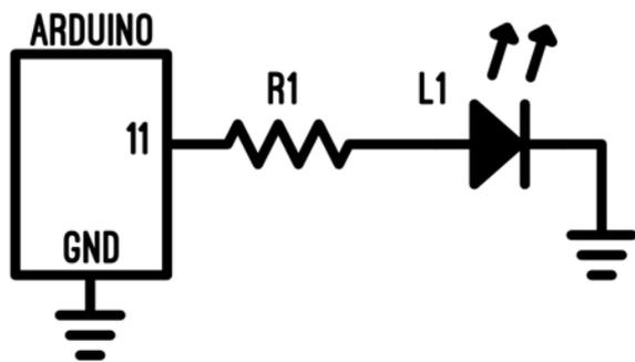
Fig 5.11 - Schema elettrico del circuito con il LED e Arduino.
