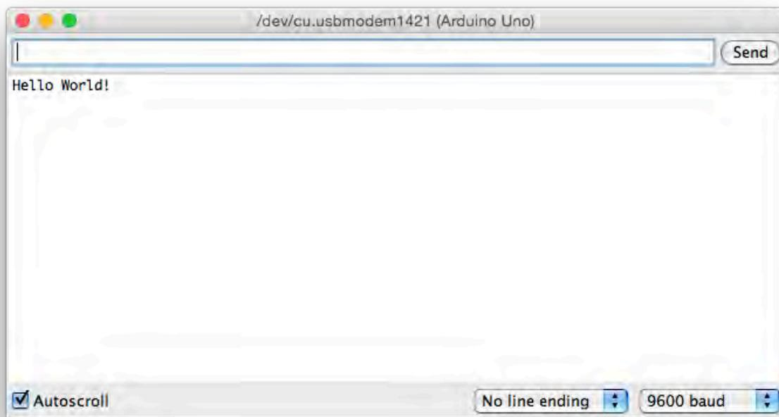
*Fig 5.19 – Il serial monitor riceve i messaggi inviati da Arduino.*
