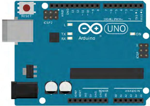
Fig 5.6 – Arduino UNO ha 14 pin digitali che possono comportarsi come ingressi o uscite.
