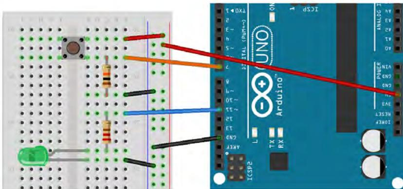
Figura 5.15 – Arduino collegato a un pulsante sul pin 7 e a un LED sul pin 11.
