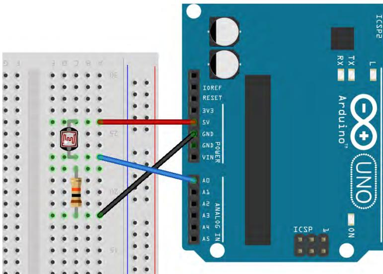
Fig. 5.22 – realizzazione del circuito su una breadboard.
