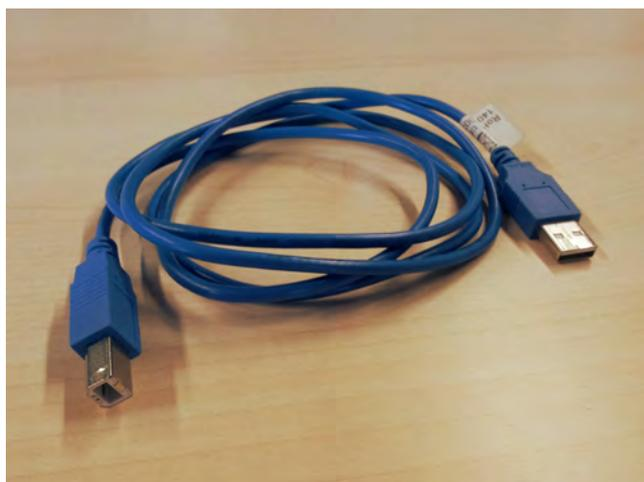
Fig 3.3 – Cavo USB di tipo A-B, adatto per Arduino UNO.
