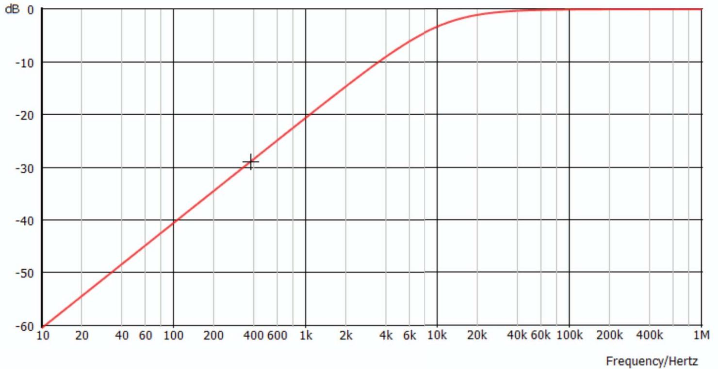
Il diagramma mostra come vengono modificati i segnali alle varie frequenze nel passaggio attraverso il filtro. La carta semilogaritmica permette di visualizzare il comportamento da 10 Hz a 1 milione di Hz (1 MHz).
